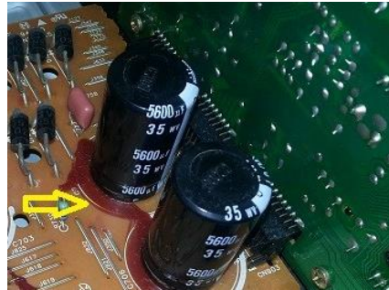
Figure 24 Sens d'un condensateur : la bande claire indique la borne -
