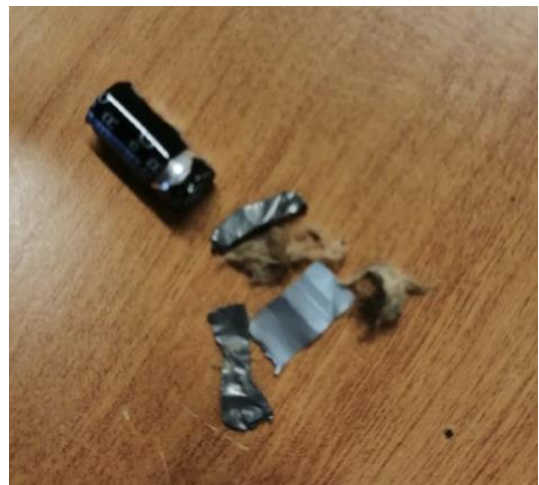
Figure 9 Condensateur qui a explosé
