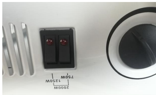
Figure 6 Exemple d'interface d'un radiateur électrique défectueux avec sélecteur de puissance
