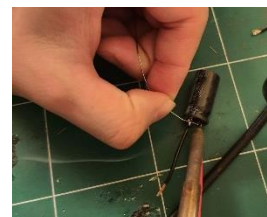
Figure 16 Soudure de fils souples aux pattes
