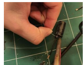
Figure 16 Soudure de fils souples aux pattes
