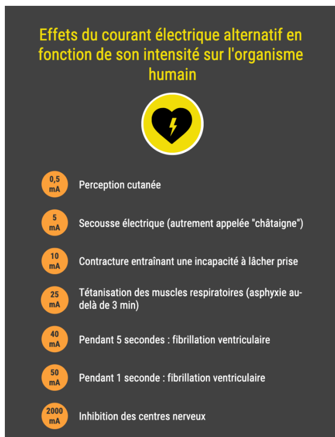
Figure 1 Ordres de grandeur d'électrisation
