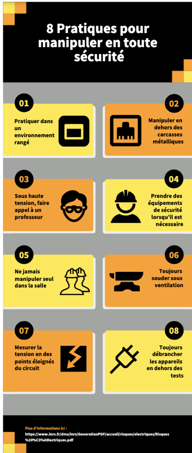
Figure 2 Règles de sécurité au CRACS
