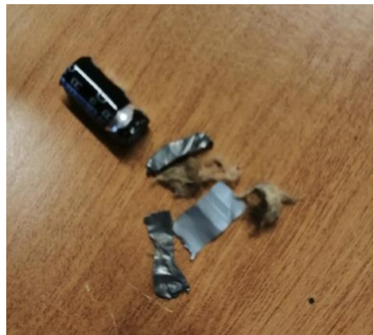
Figure 9 Condensateur qui a explosé
