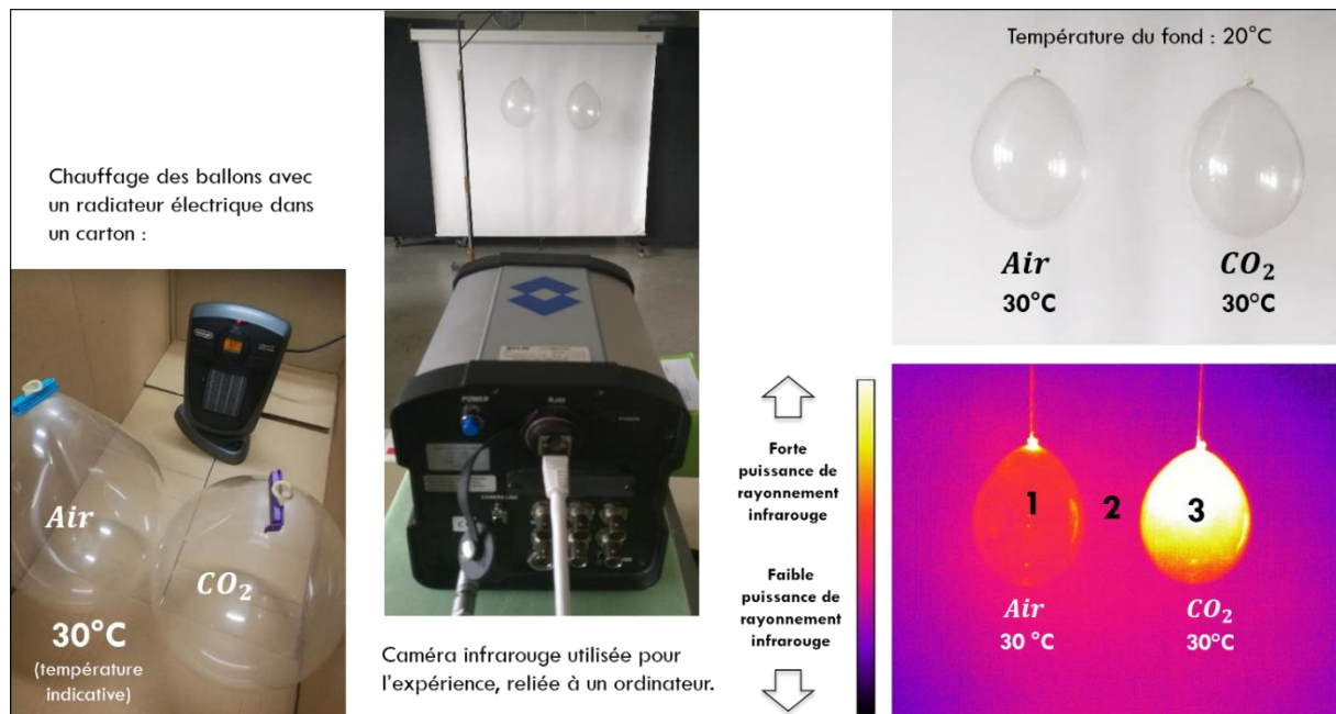
Figure n°17 - Ballons d'air et de CO 2 chauds observés avec une caméra infrarouge
