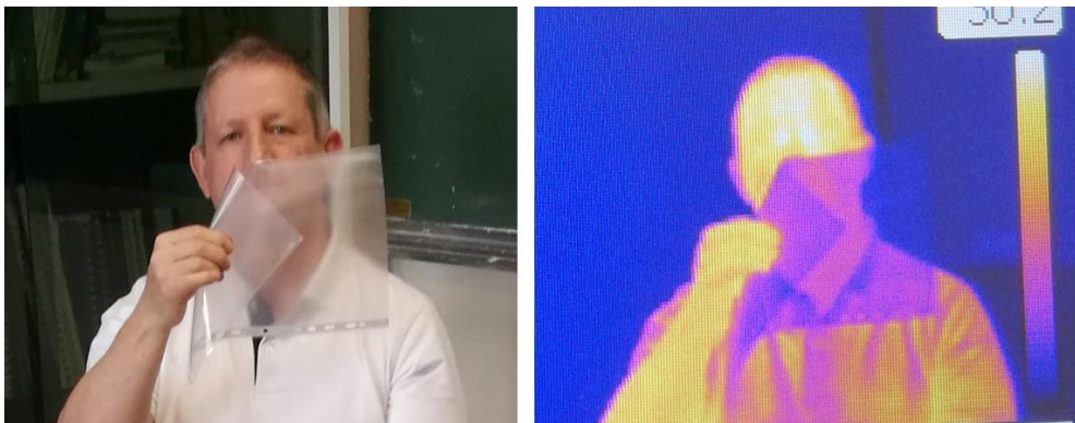
Figure n°15 – Transparence infrarouge d’une pochette plastique, en fonction de l’épaisseur traversée (simple ou double)
