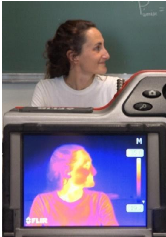
Figure n° 7 – Caméra infrarouge, ou improprement appelée aussi caméra « thermique »
