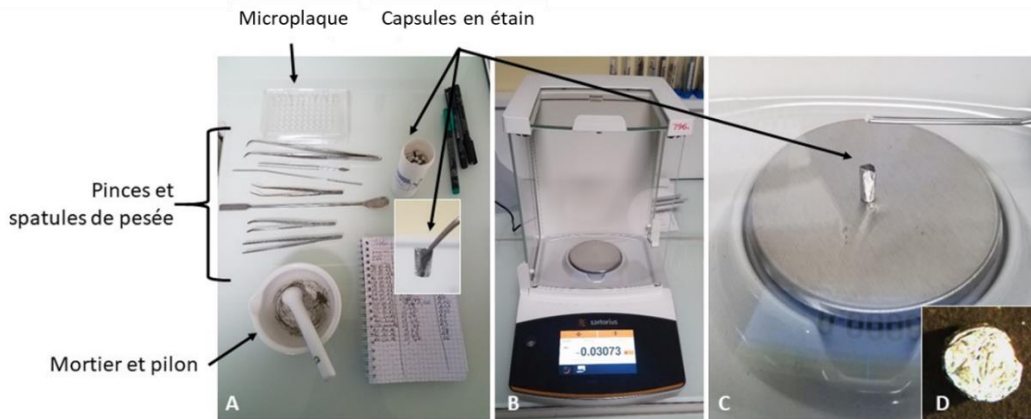
Figure 19 : Matériel de pesée des échantillons en vue d'une analyse des ratios isotopiques du carbone et de l'azote (©INRAE L. Carassou, D reproduit de 1 ).
