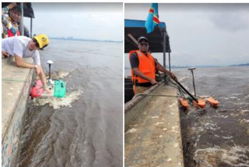
Figure 1: déploiement des ADCP SonTek M9 (à gauche) et TRDI RioGrande (à droite) sur les deux pinasses
