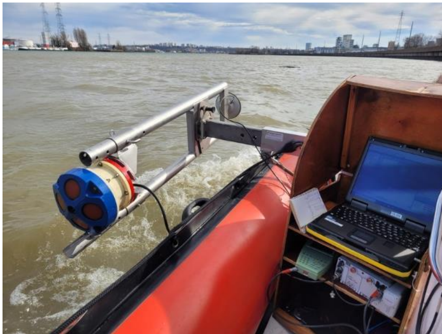
Figure 21 : Potence ADCP réglable et console de protection/commande
