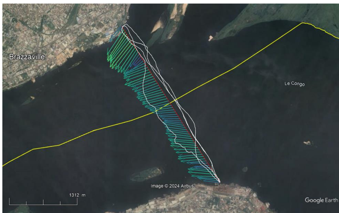
Figure 17 : Position du transect Brazzaville-Kinshasa et données ADCP moyennées sur la verticale pour le transect 4 (RG 600 kHz). Image Google.
