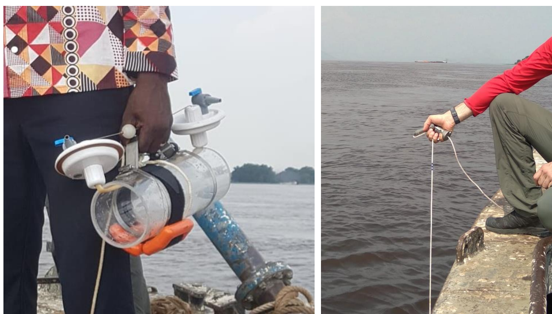
Figure 3 : Bouteille horizontale prête à échantillonner (à gauche), messenger prêt à être envoyé pour fermer la bouteille à la profondeur voulue (à droite).
