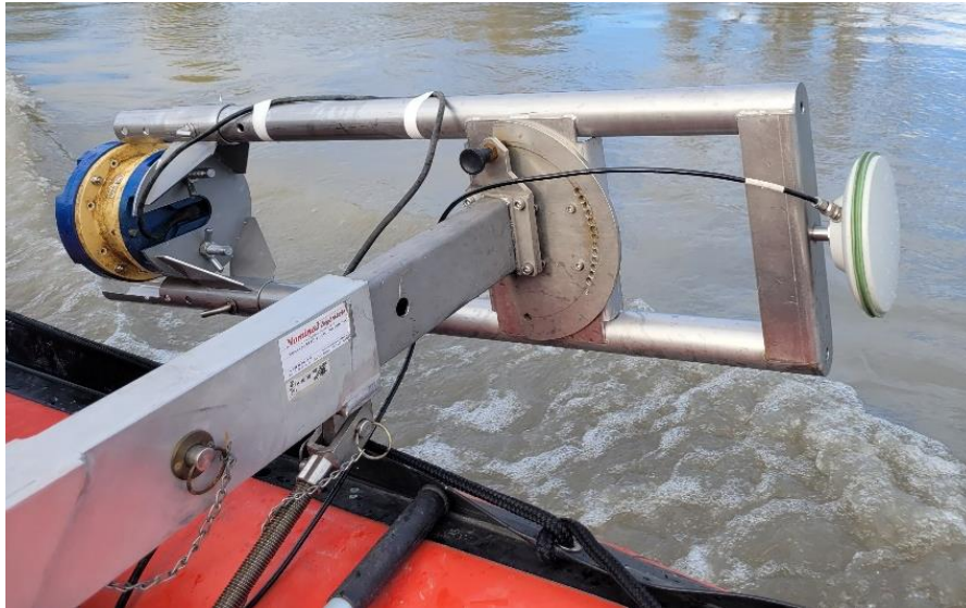
Figure 20 : Potence ADCP réglable avec antenne GPS (INRAE)
