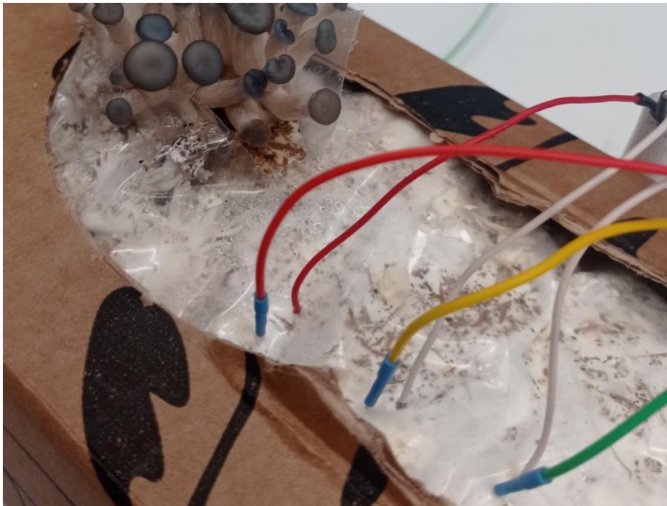
Figure 3 : Monitoring du mycélium de la boîte à champignon au moyen de deux types d'électrodes.
