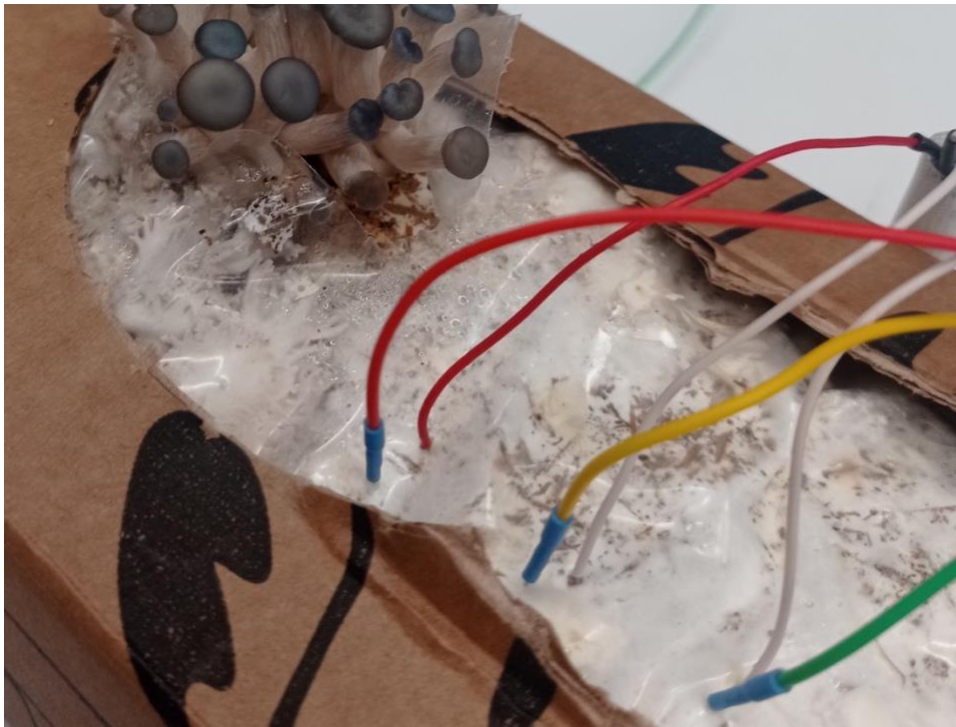
Figure 3 : Monitoring du mycélium de la boîte à champignon au moyen de deux types d'électrodes.
