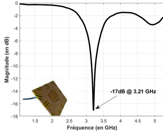
FIGURE 3. Paramètre  $|S_{11}|$  de l'antenne en MDF hors enceinte climatique
