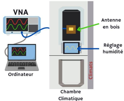
FIGURE 4. Banc de mesures en enceinte climatique
