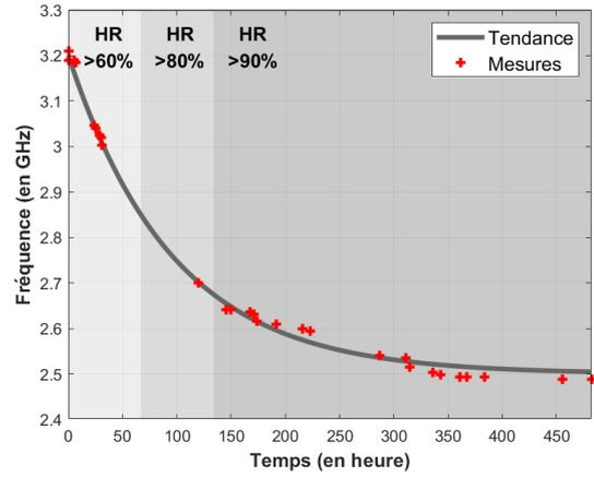
**FIGURE 7. Évolution de la fréquence de résonance en fonction du temps**
