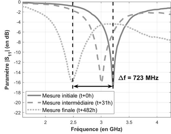
**FIGURE 6. Variation du paramètre  $|S_{11}|$  de l'antenne pendant la prise d'humidité**
