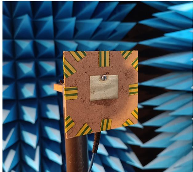
FIGURE 1. Antenne en MDF dans la chambre anéchoïque
