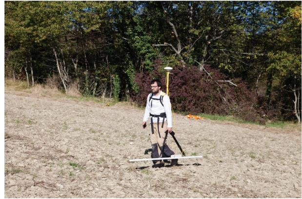
fig. 38 : Dispositif électromagnétique basse fréquence – GEM2 Geophex
