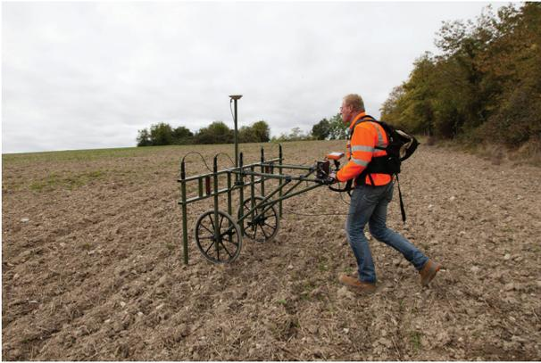
fig. 37 : Dispositif magnétique – Sensys MXPDA
