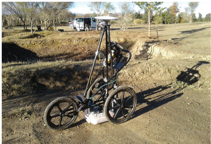
fig. 39 : Dispositif radar-sol – GSSI SIR3000 – photographie prise sur le site d'étude . (F.-X. Simon, Inrap)
