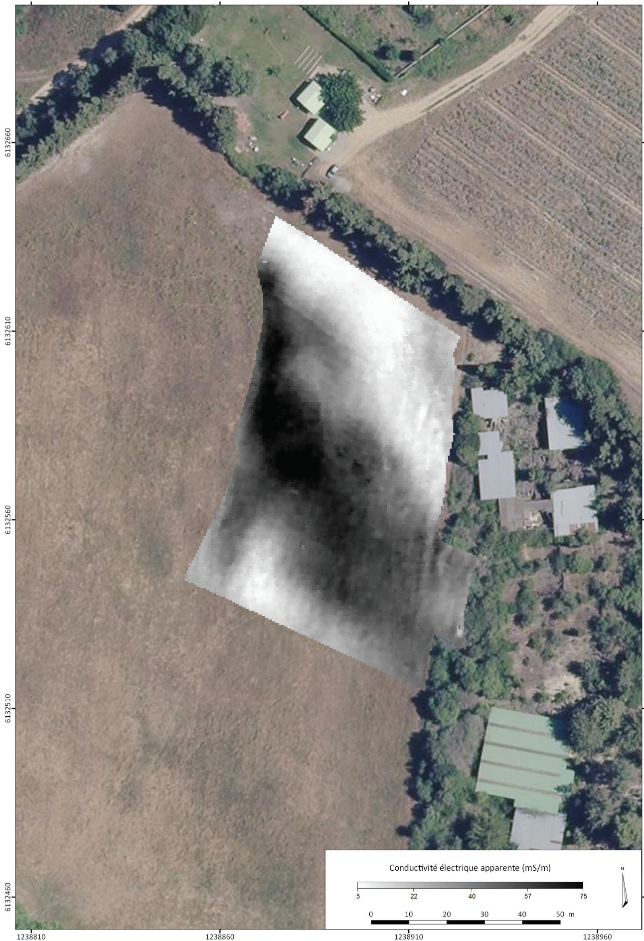
fig. 43 : Carte de conductivité électrique apparente – Fond : Orthophotographie aérienne - source IGN . (F.-X. Simon, Inrap)
