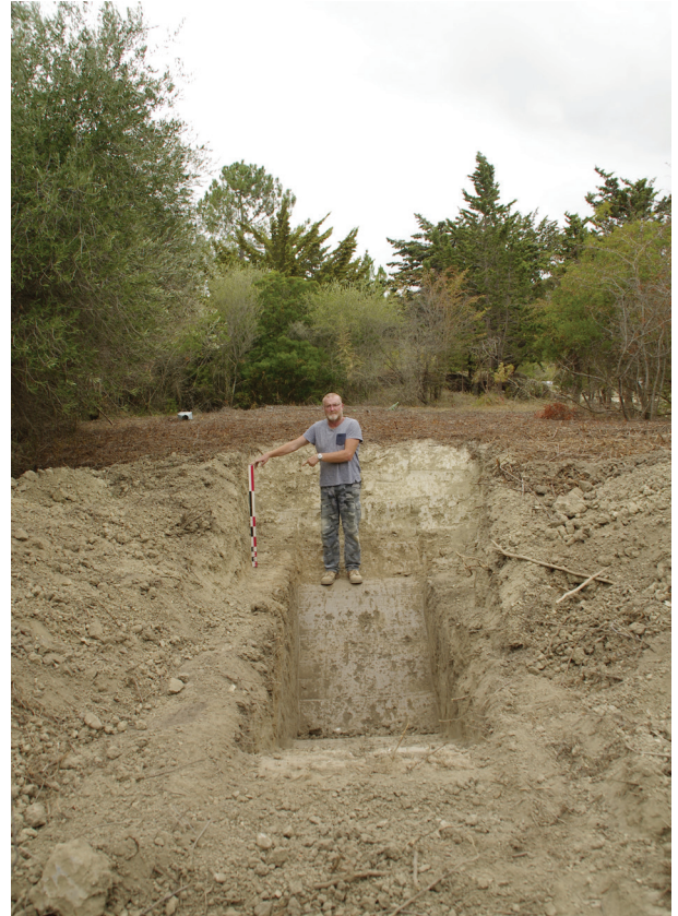
fig.19 : sondage pour déterminer l'épaisseur du remblaiement dans le petit talweg (L. Vidal Inrap).
