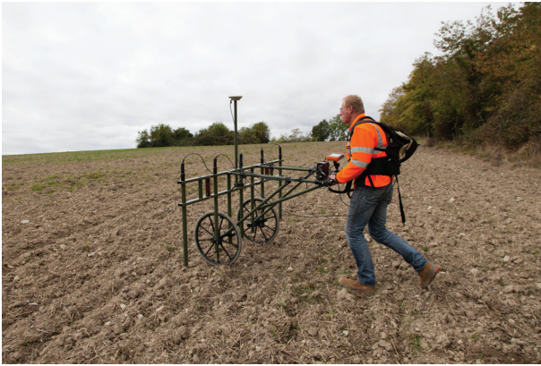
fig. 37 : Dispositif magnétique – Sensys MXPDA
