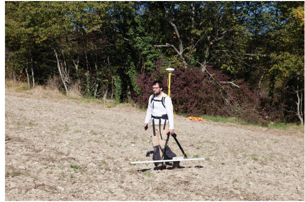
fig. 38 : Dispositif électromagnétique basse fréquence – GEM2 Geophex
