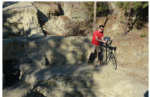
fig.21 : mise en place d'une session de scanner-laser (L. Vidal, Inrap).
