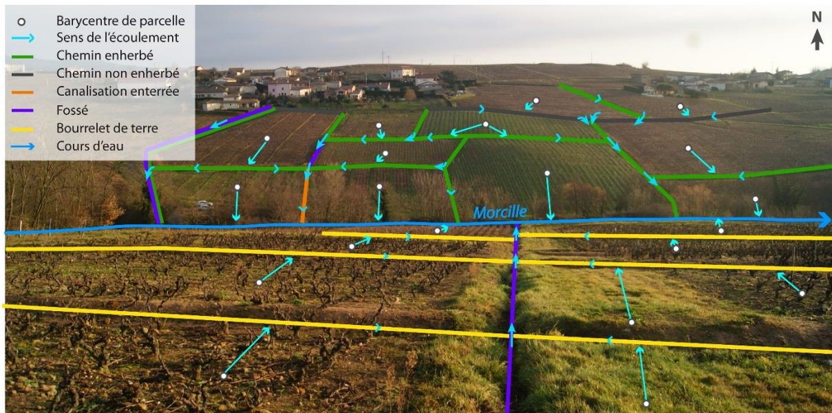
Figure 72 : Schéma d'organisation du cheminement des sédiments dans le paysage, bassin versant de la Morcille (Pic, 2023)
