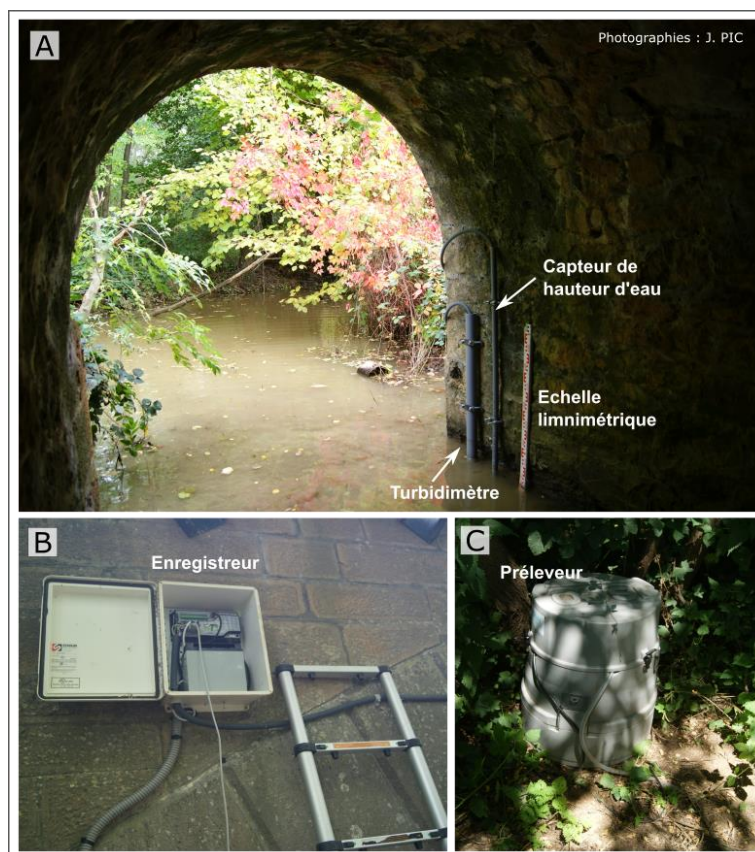
Figure 8 : Illustration des capteurs en place sur le terrain (A) sonde pression et turbidimètre en rivière, (B) enregistreur et (C) préleveur automatique (Pic, 2023)
