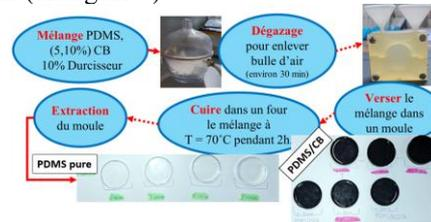
Figure 9. Process de fabrication du PDMS.
