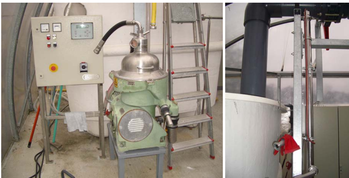
Figure 12 : Le clarificateur de récolte, à gauche, et le stérilisateur UV du surnageant recyclé, à droite.
