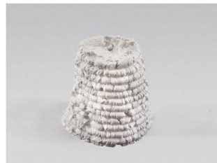
Fig. 3. Rampe d'extrusion. Trajectoire paramétrique dessinée sur Rhino-grasshopper et photographie de l'objet de porcelaine produit. La distance de captation ne varie pas significativement, l'extrusion s'achève lorsque le robot se retire de la zone de déposition.
