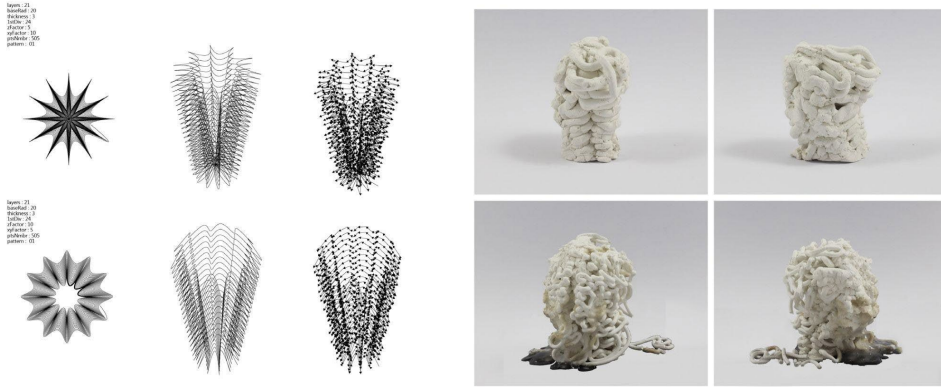
Fig. 4. Rampes d'extrusion modifiées. La distance de captation varie en fonction des sinuosités de la trajectoire et du fil en cours de déposition. La rencontre d'une infructuosité génère une symétrie ou un motif imprévu. L'analyse de la génération de cet objet-texture permet de programmer une nouvelle trajectoire reproduisant volontairement ces motifs ou asymétries.
