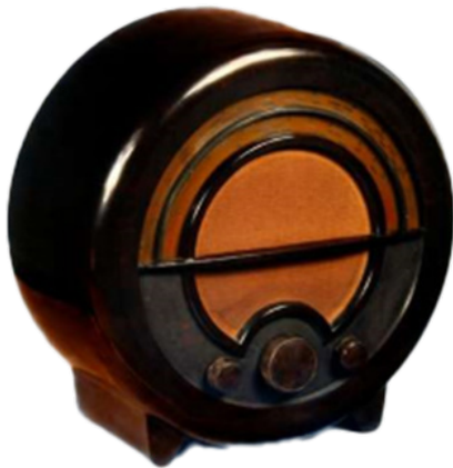
Figure 3 : Exemples d'une radio Ekco de 1934 (Source : Mayor Gallery, London / Bridgeman Images) et d'un téléphone Siemens de 1932 (Source : Museum of Design in Plastics) en bakélite.
