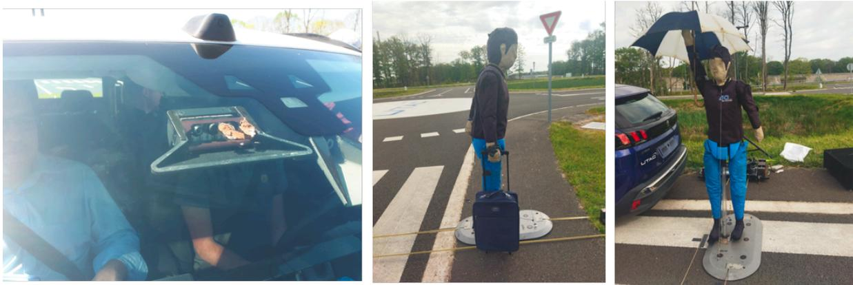
**FIGURE 3.10** – Exemples de tests de robustesse aux salissures caméra ou aux aspects piétons.
