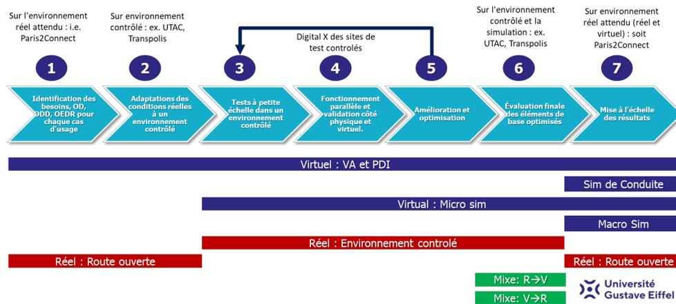
**FIGURE 3.1** – Vue d’ensemble des différentes étapes entrant dans la méthodologie proposée d’évaluation et de validation des systèmes de mobilité automatisée. Ce schéma permet de voir les différents types de moyens d’essais applicables pour chaque étape.
