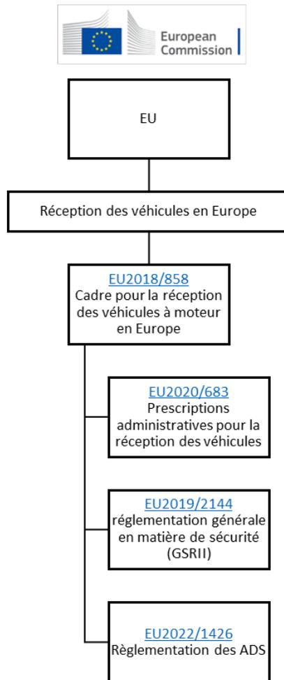
**FIGURE 2.6** – Cadre réglementaire en vigueur actuellement pour l’homologation d’un véhicule équipé d’un ADS
