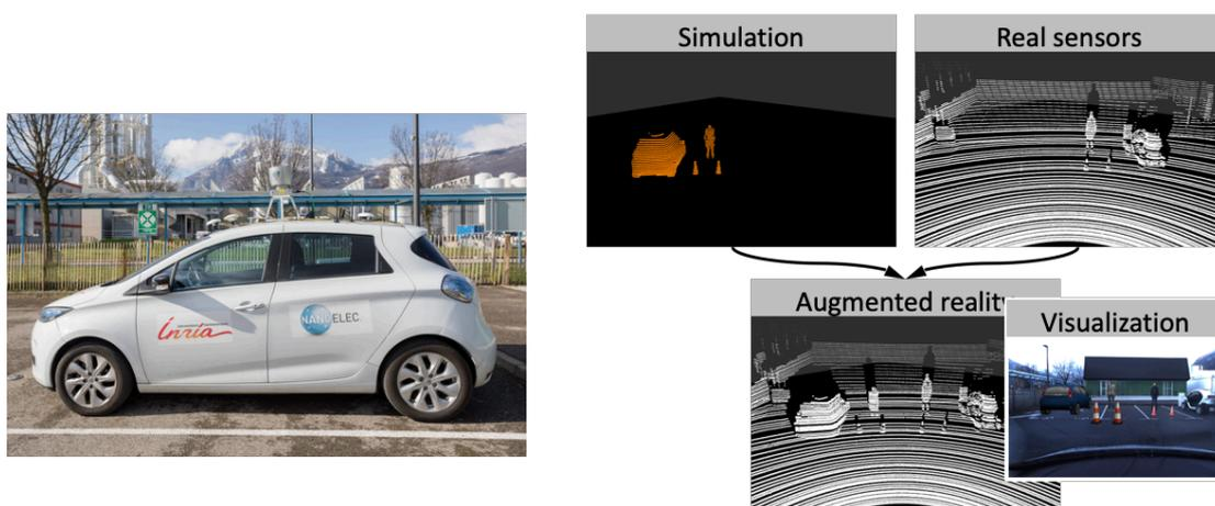
**FIGURE 3.15** – Exemple de test réalisé en réalité augmentée, où des obstacles virtuels sont ajoutés au monde réel dans lequel évolue le véhicule.
