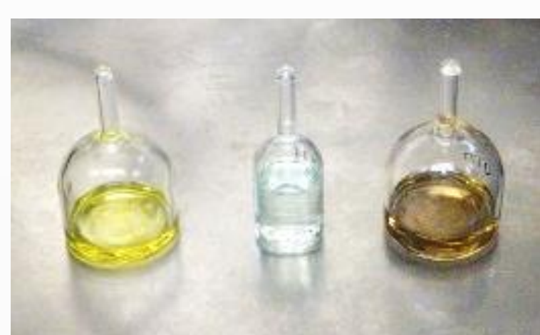
Solutions étalon certifiées d'U, Np et Pu produites et commercialisées par la CETAMA
