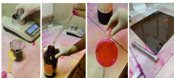
Figure 4 - Dosage de la Rhodamine B, dilution dans l'éthanol, mélange avec la résine époxy puis dépôt sur le film mince
