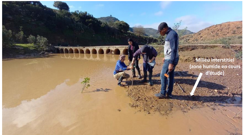
FIGURE 2 : Milieu interstitiel prospecté en utilisant la pompe Bou-Rouch.
