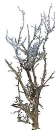
Figure 6. Nuages de points 3D d'un arbre à trois années différentes (2020-2022), résultats issus de la numérisation par LiDAR terrestre.
