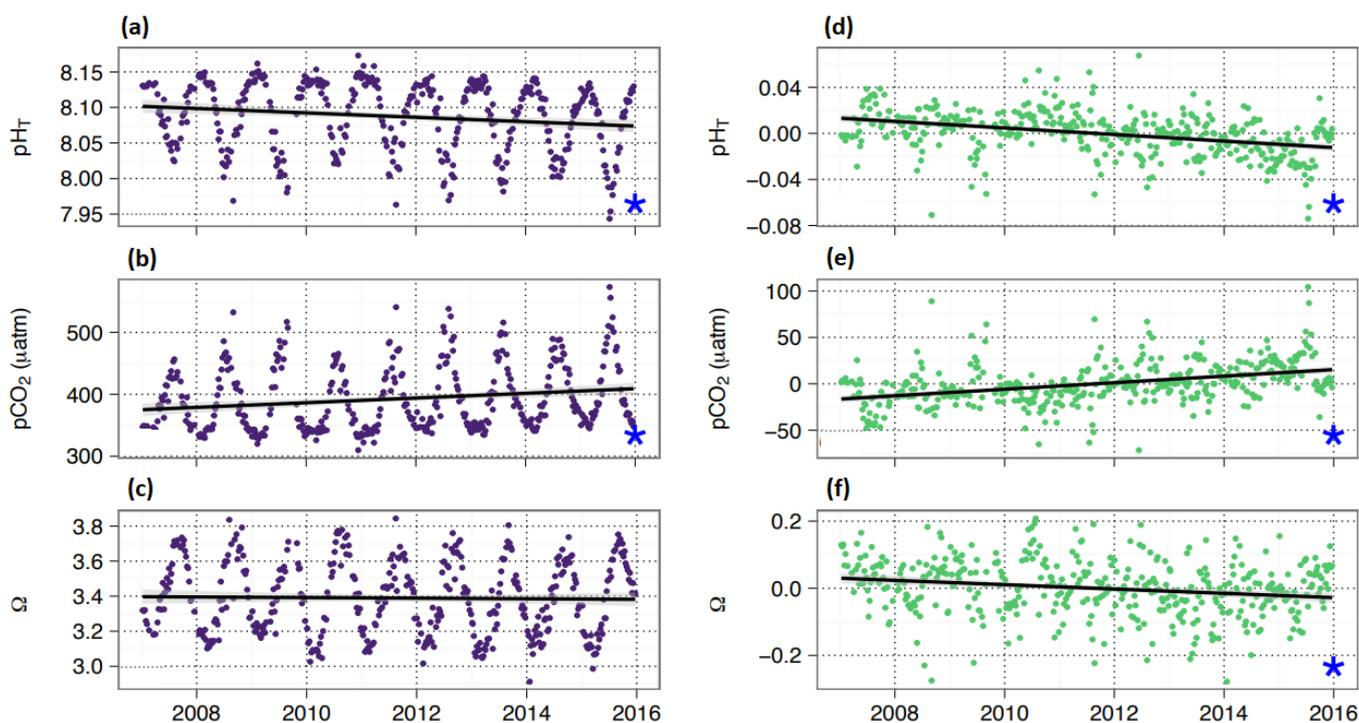
Figure 2 : Série temporelle *in situ* (a-c) et anomalie (d-f) de pH,  $p\text{CO}_2$  et  $\Omega$  au large de Villefranche-sur-Mer avec les droites de régression (significatives à  $\alpha = 0.05$  pour les étoiles bleues) (source : Kapsenberg et al., 2017).
