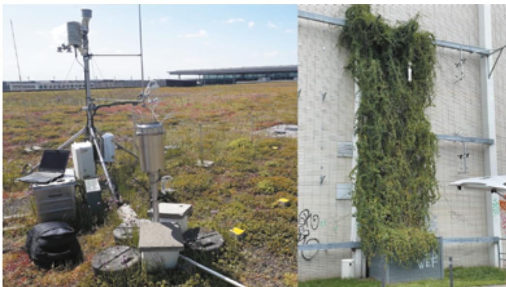
Sites expérimentaux du projet GREENVELOPPE : mesures des flux d'énergie, d'eau et de CO<sub>2</sub> sur un toit végétalisé de l'aéroport de Berlin (BER airport, à gauche), et mesures de bilan radiatif sur une façade végétalisée de l'université TU Berlin (à droite). Ces mesures sont utilisées pour la validation du schéma d'enveloppes végétalisées dans le modèle urbain TEB.
