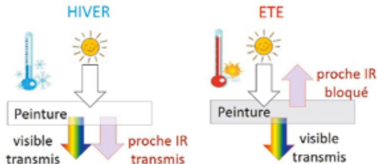
Principe de fonctionnement de la peinture thermochrome développée dans le projet THERMOCOAT.
