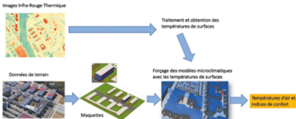
Principe d'utilisation des images infrarouges thermiques dans les modèles microclimatiques.
