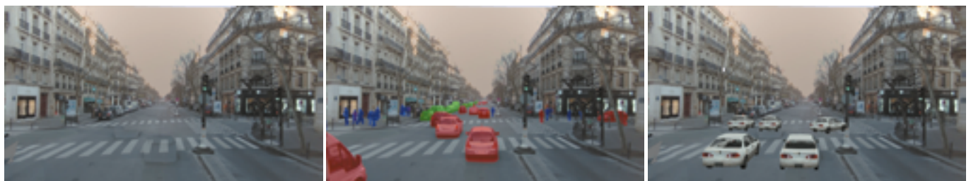
Détection d'objets mobiles (à gauche), visualisation de la ville dépeuplée (au centre), visualisation de la ville repeuplée par simulation (à droite). © M. Brédif, IGN, projet iSpace&Time.
