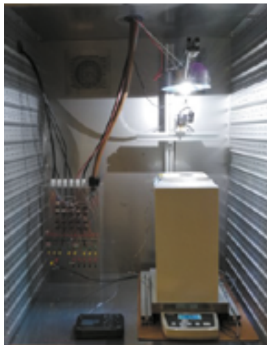
Photographie (gauche) et schéma (droite) du dispositif expérimental mis au point pour l'étude thermo-climatique des toitures-terrasses.
