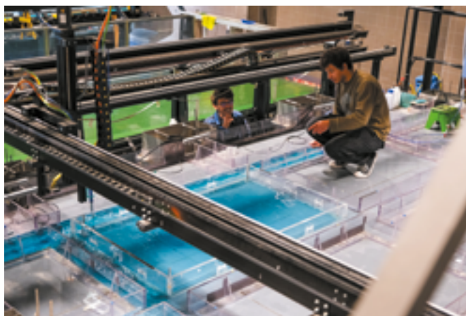
Modélisation expérimentale d'une inondation dans un réseau de rues avec échanges d'eau (à travers 12 ouvertures) entre rue et bloc de bâti.
