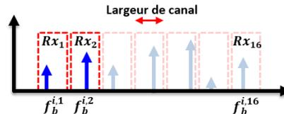
Figure 2 : Multiplex fréquentiel BF des voies de réceptions
