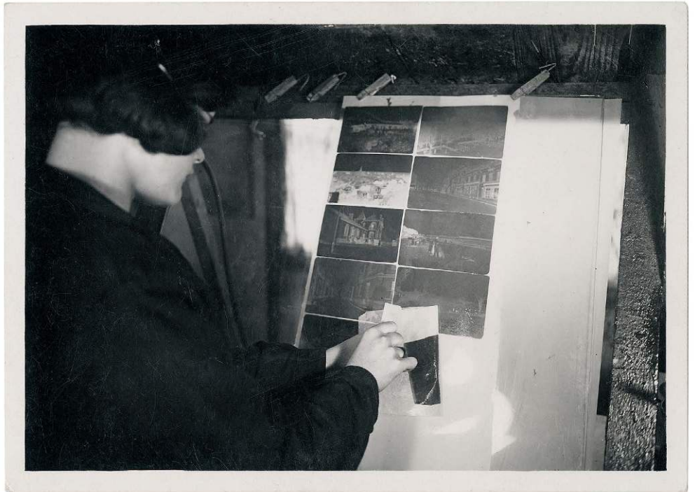
Fig. 11 Entreprise Combier (CIM), Galerie d'insolation des clichés dans des châssis pour l'impression de cartes postales, ca. 1930. Inversion numérique d'après un négatif sur verre au gélatine-bromure d'argent, 13 × 18 cm. Chalon-sur-Saône, Musée Nicéphore Niépce.
