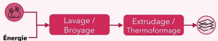
Le procédé historique du recyclage, représentant actuellement 99,9% du recyclage en Europe. Avec 5,5 millions de tonnes de matières recyclées utilisées dans la production en 2021. Le facteur limitant le développement de cette technologie réside dans le tri, le flux d'entrée nécessitant d'être monomatériau et de répondre à certains critères de qualité<sup>44</sup>.
