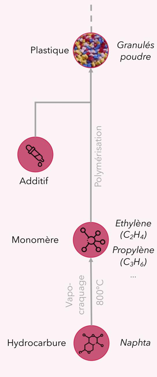
Fig 7.2 Chaîne des procédés en jeu dans la fabrication d'un objet en plastique
