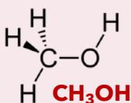
Le **méthanol** est un des **produits chimiques les plus produits au monde**, il est utilisé pour les **carburants** et comme **précurseur à d'autres produits chimiques**. Il est aujourd'hui obtenu par reformage à la vapeur du gaz naturel, mais aussi par gazéification du charbon. Le volume de **production** européen est de **1,5 Mt aujourd'hui** et pourrait atteindre **2,2 Mt en 2050** notamment dû à la filière des oléfines.
