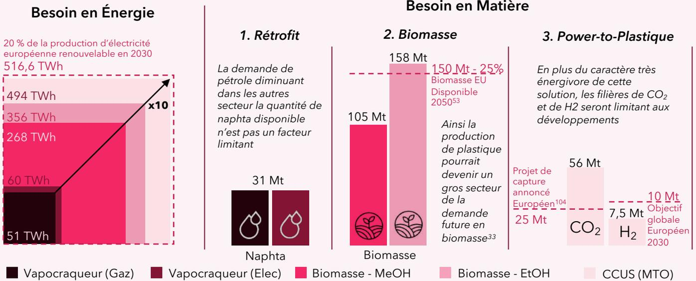
Fig. 30. Besoin en énergie et matière des différents processus de production Source<sup>66,81,82</sup>
