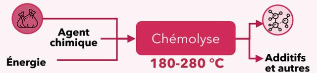
Certains processus de chémolyse tels que la glycolyse sont appliqués à grande échelle DuPont/DOW, Goodyear, Shell... L'hydrolyse a également été appliquée à une échelle commerciale et pilote, tandis que la méthanolyse est en développement
