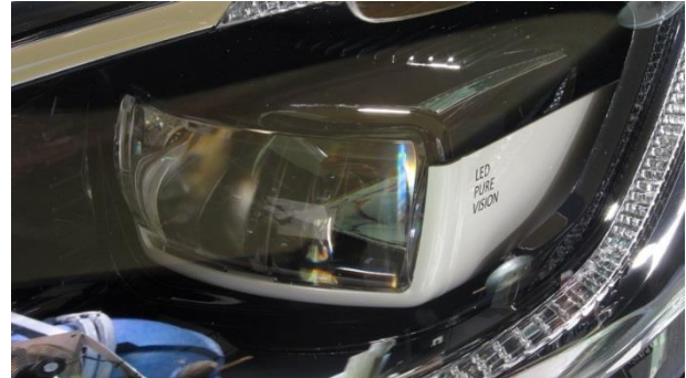
Agrandissement sur le module du feu de route
