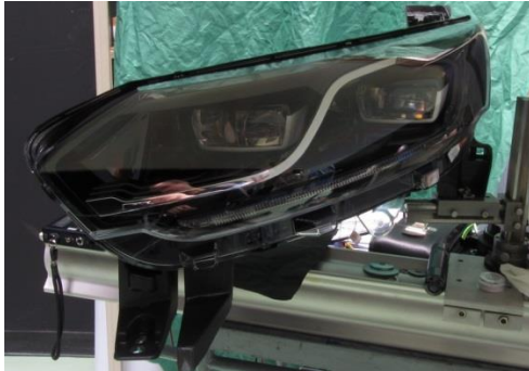
Projecteur sur le support de mesure
