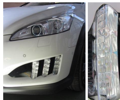
Photo CSTB du véhicule testé. Agrandissement sur le DRL
