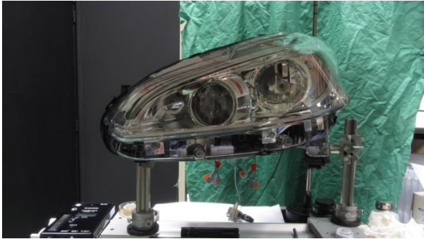
Projecteur sur le support de mesure
