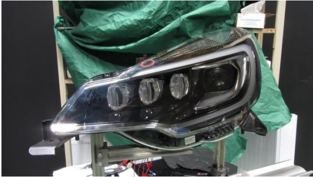
Projecteur sur le support de mesure
