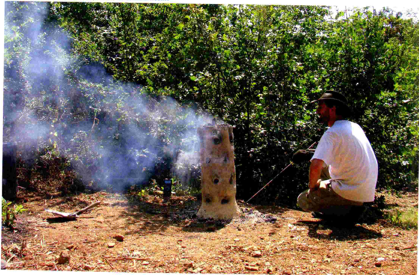
Abb. 16: Rekonstruktion eines huayrachina für Schmelzversuche
