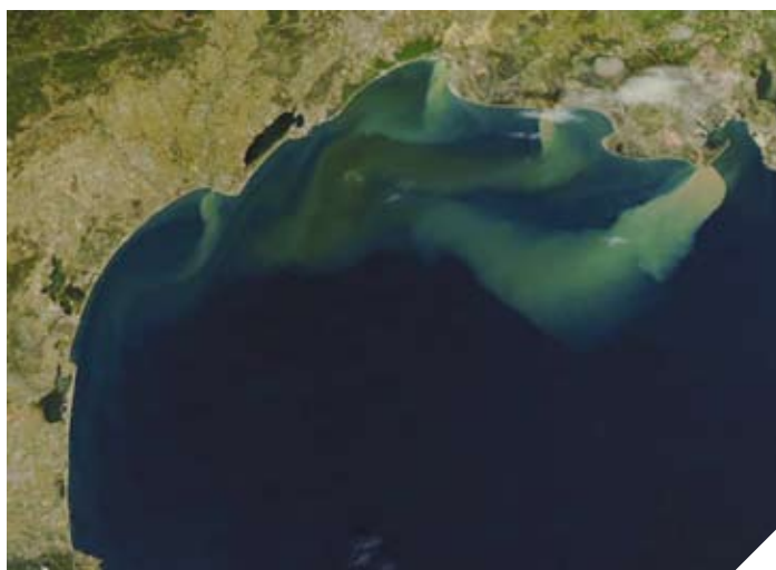
Le panache à l'embouchure du Rhône en Novembre 2002. Lors des crues, la majeure partie des apports, expulsée dans le « panache », n'alimente pas les plages du delta (© Nasa Earth Science Photos Archives).
