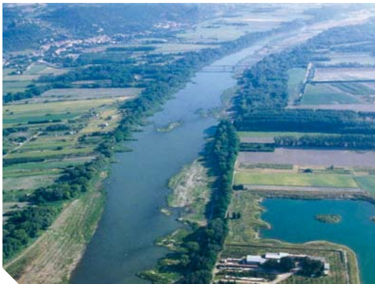
Le Vieux-Rhône de Montélimar. À l'intérieur de son double cordon de forêt alluviale qui délimite l'ancien chenal navigable, le chenal en eau actuel dessine la partie du chenal approfondie par les travaux « Girardon » entre les bancs de galets latéraux.
