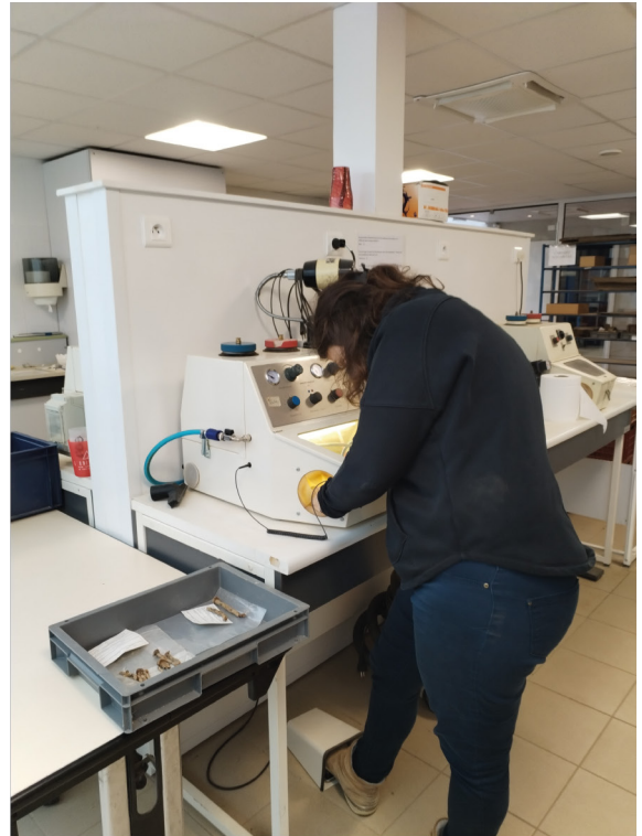
Micro-sablage des vestiges ferreux
