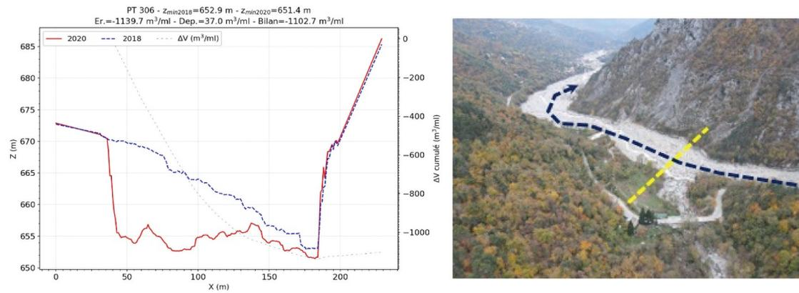
**Figure 3.** (gauche) Évolutions d'une section en travers avant (pointillés bleus) et après (trait continu rouge) crue au droit du cône de déjection de l'Espaillart affluent de la Vésubie ; (droite) Photographie post-crue correspondante (source : F. Adamo, Cerema).
