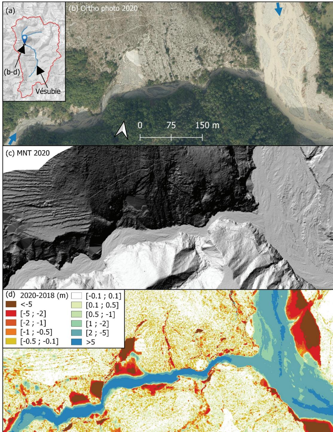
**Figure 5.** Confluence entre la Vésubie et le Venanson, exemple de remplissage des fonds de vallée et des érosions massives des berges et versants, a) localisation, b) ortho-photo post événement (levé d'urgence IGN 2020), c) MNT post événement (levé d'urgence IGN 2020), d) différentiel altimétrique entre MNT pré-événement et MNT post-événement réaligné.
