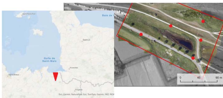
Figure 1. Cartographie du site d'études (rectangle rouge) et localisation des cibles géoréférencées (points rouge).
