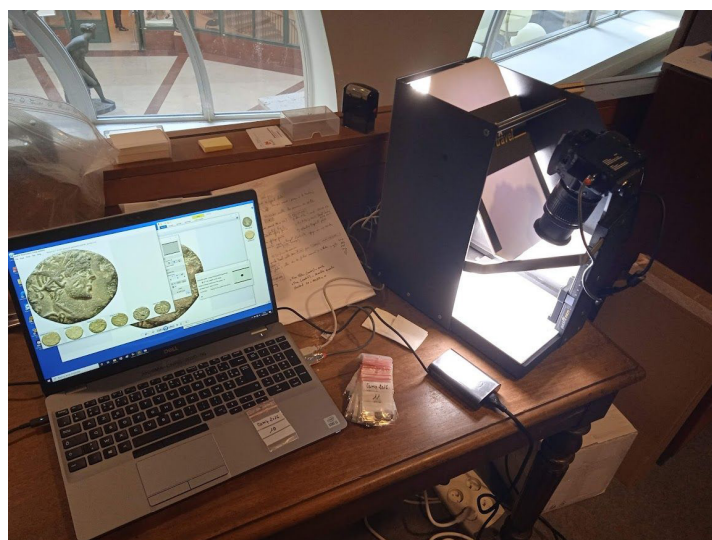
Fig. 84 : Vue du portique de prises de vue « QuickPX travel » en cours d'utilisation.
