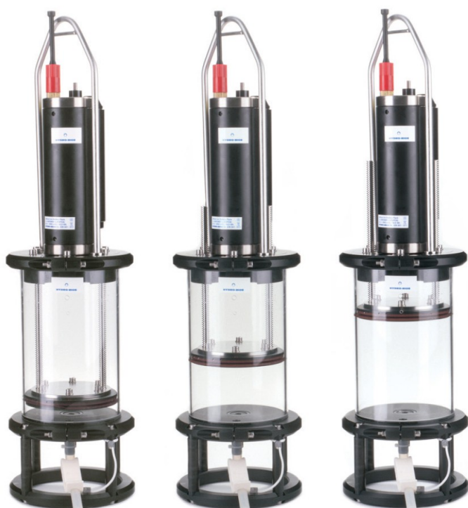
Photo 1 Appareil intégrateur IWS collecteur de la chlorophylle a et du phytoplancton, avec le piston observé dans différentes positions. Le volume maximum pouvant être prélevé est de 5 litres
