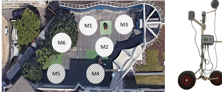
Figure 2 : Points de mesures dans la cour (gauche) et photo de la station mobile (droite).
