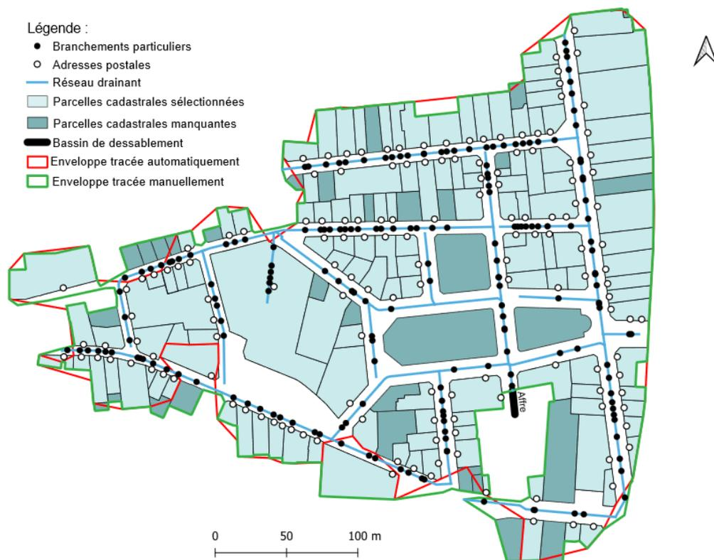
Figure 10 : comparaison des deux zones d'apport tracées automatiquement (en rouge) et manuellement (en vert).
