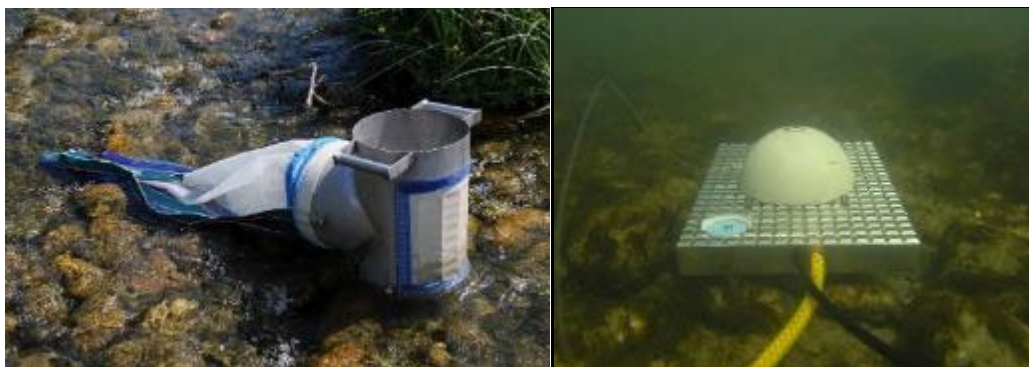
Photos 5-1.1-5-1.2 - Photo 5-1.1, à gauche, cylindre de Hess (Montélimar, 24/04/2014). Photo 5-1.2, à droite, mesure des contraintes au fond par la méthode des hémisphères (Montélimar, 27/05/2012).
