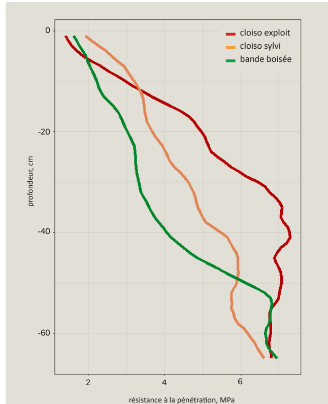
↑ Figure 5. La résistance à la pénétration augmente avec la profondeur et l'intensité de la circulation
