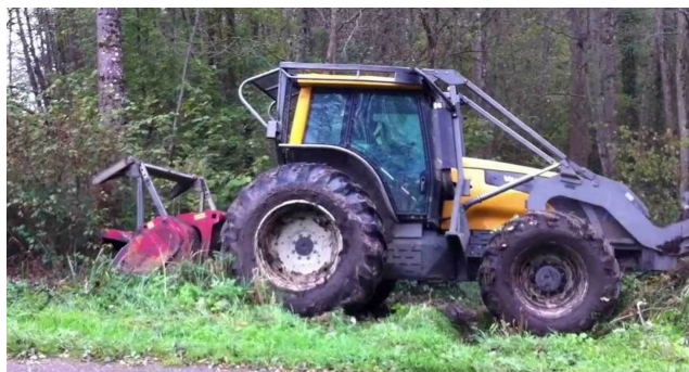
Type d'équipement (tracteur + broyeur) souvent utilisé pour l'entretien des cloisonnements
