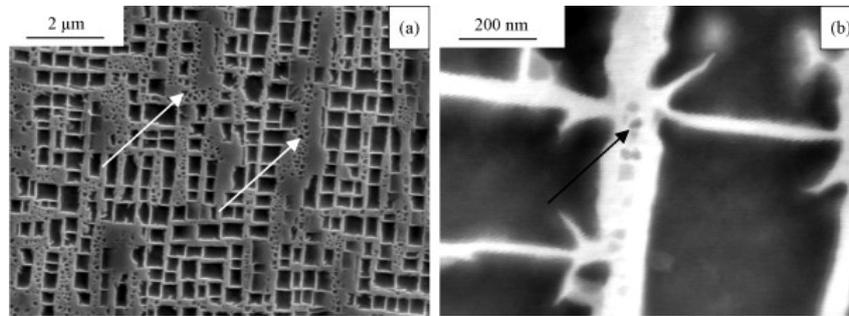
FIGURE 2 – Représentation d’une microstructure de superalliage MC2 après 180s de surchauffe : (a) vue globale avec indication des couloirs  $\gamma$  où se produisent des précipitations  $\gamma'$  tertiaires, (b) zoom sur un couloir de précipitation tertiaire (images issues de [3]).
