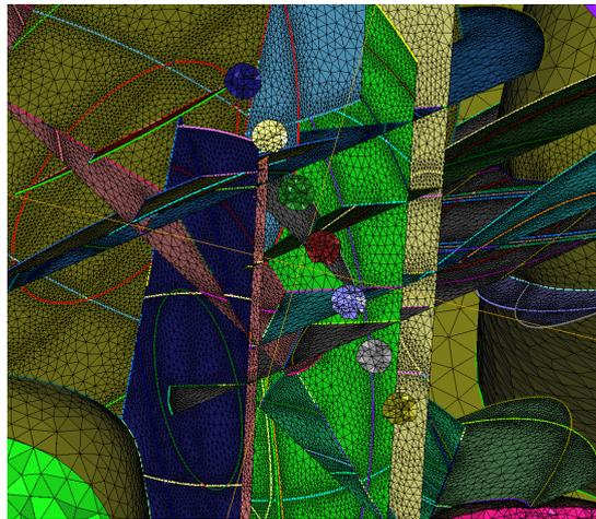
FIGURE 4 – Représentation du maillage surfacique au sein d'un couloir de nickel, avec 5 précipités  $\Gamma'$  tertiaires alignés (au centre), et une cinquantaine de boucles de dislocation elliptiques (dont les plans de cisaillement sont maillés).
