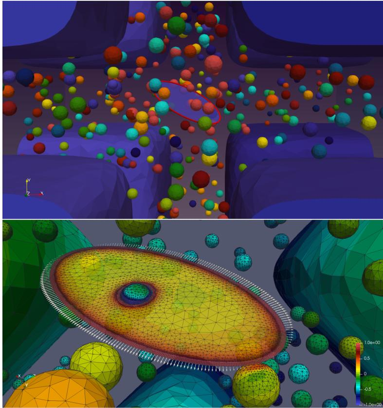
FIGURE 6 – Représentation d’une boucle de dislocation elliptique au milieu d’un couloir, en présence de 500 précipités  $\gamma$  tertiaires dans une microstructure sollicitée en compression, en haut, isovaleurs du champ de contrainte dans la direction du chargement imposé et vecteurs représentatifs des forces de Peach-Koehler (en gris) le long du coeur de la dislocation.
