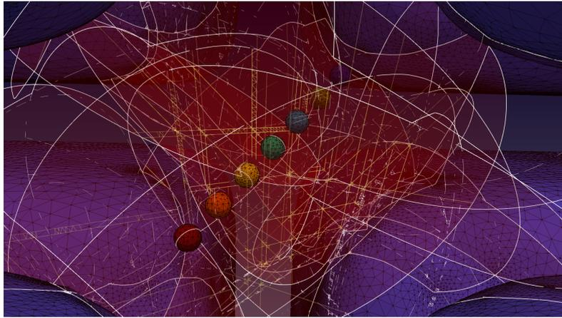
FIGURE 5 – Représentation par éléments finis d’un couloir de phase  $\gamma$  constitué de 80 boucles de dislocations (coeur en blanc et surfaces cisailées en rouge transparent) et 5 précipités  $\gamma$  tertiaires sphériques alignés au centre (dans la direction 111).
