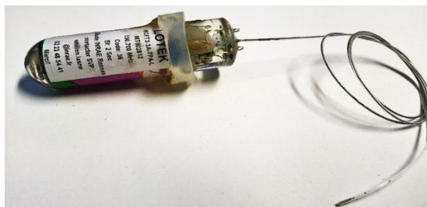
Figure 7 : Emetteurs-DST Lotek® du modèle [MCFT3-3A-TPA-L](#). Un anneau de silicone est placé autour de l'émetteur de façon à augmenter la rétention gastrique.
