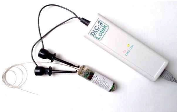
Figure 8 : Module de communication Lotek® DLC-2
