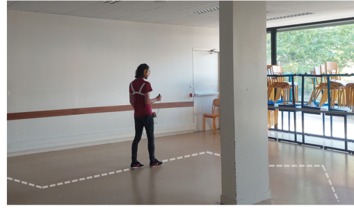
FIGURE 1. Notre poignée haptique fournit un retour vibrotactile localisé dans la main de l'utilisateur grâce à 4 moteurs vibrants isolés par une structure souple imprimée en 3D (à gauche). Dans une étude utilisateur, nous évaluons trois stratégies de navigation avec deux ensembles de stimuli tactiles, en demandant aux participants de suivre un chemin invisible en utilisant les informations fournies par la poignée haptique (droite).
