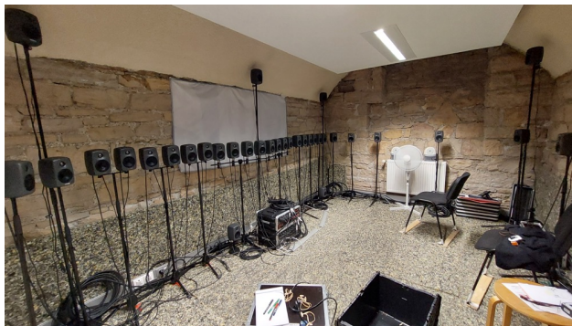
Couronne de 46 enceintes – MSH-LSE Latéralisation et élévation en collectif
