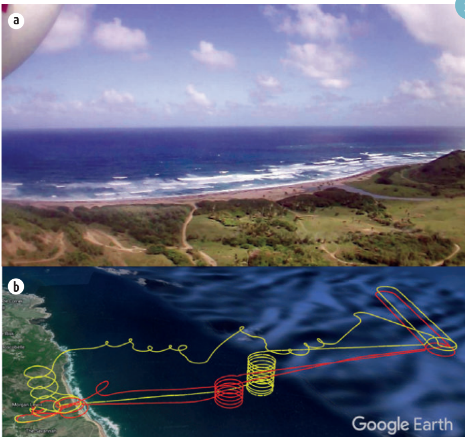
(a) Image de la caméra embarquée sur le drone en volant vers la mer, avec la cote de la Barbade et les cumulus alizés. (b) Trajectoires de deux drones volant simultanément en suivant un nuage d'une manière adaptative. La zone E1 est la zone de décollage ; la zone E2 représente la phase de montée ; la zone E3 correspond aux hippodromes dans l'attente d'intercepter un cumulus ; et la zone E4 correspond au suivi adaptatif du cumulus. Tiré de Hattenberger et al. [2021].
