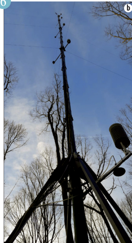
Cycle diurne de la moyenne mensuelle des flux de chaleur sensible et latent sur le maïs et la forêt lors de la campagne MOSAI pour le mois d'avril, mai et juin 2023. Photo du dispositif expérimental en forêt déployé par l'équipe DESR/CNRM/GMEI/4M.
