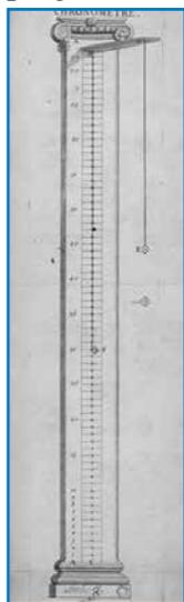
Fig. 3 : *Éléments ou principes de musique*, Étienne Loulié (Paris, 1696) : planche du « chronomètre », nouvelle invention d'un pendule à longueur modulée permettant de mesurer et reproduire le tempo d'une pièce musicale. Source : [gallica.bnf.fr/ark:/12148/bpt6k15178937/f91.item](http://gallica.bnf.fr/ark:/12148/bpt6k15178937/f91.item).
