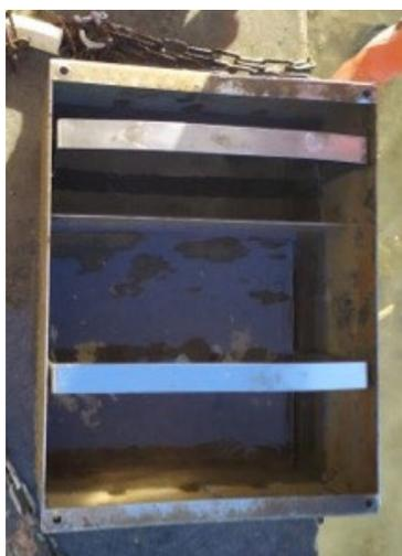
Figure 1 - Photo du piège à particules utilisé
