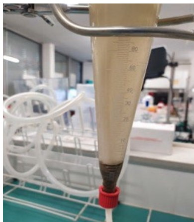
Figure 8 – Exemple de décantation en cône Imhoff d'une MES d'eau brute après 24 h de décantation
