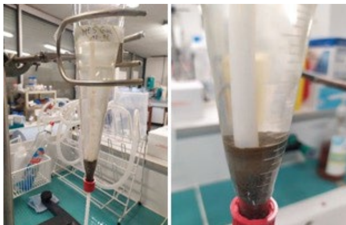
Figure 4 - Echantillon de MES de PAP après 25 h de décantation en cône Imhoff
