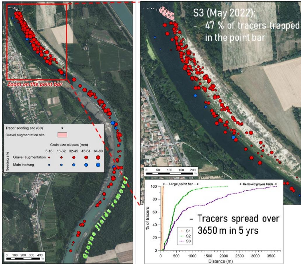
**Figure 5.** Réinjection sédimentaire de la Platière sur le Vieux-Rhône de PDR : localisation des traceurs pour le relevé S3 (à gauche), zoom sur le banc amont (en haut à droite) et courbe cumulative des traceurs en fonction de leur distance à l'injection (en bas à droite)
