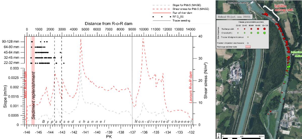
**Figure 2.** Réinjection sédimentaire de CHA : évolution longitudinale des contraintes de cisaillement et localisation des traceurs RFID en fonction de leur taille pour le relevé S5 (octobre-novembre 2022).
