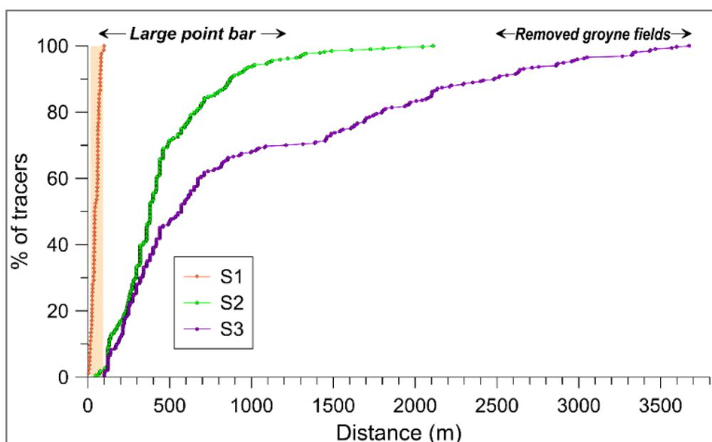
**Figure 7.** Réinjection sédimentaire de la Platière sur le Vieux-Rhône de PDR : courbes cumulatives des trois relevés RFID permettant d'identifier les secteurs d'accumulation des sédiments réinjectés (composante longitudinale uniquement)
