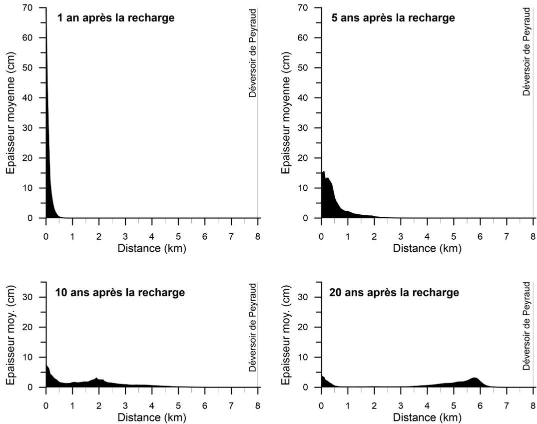
**Figure 1.** Réinjection sédimentaire de la Platière sur le Vieux-Rhône de PDR : répartition longitudinale de l'épaisseur moyenne de sédiment depuis le site de réinjection sédimentaire (= 0 km) après 1 an, 5 ans, 10 ans et 20 ans.
