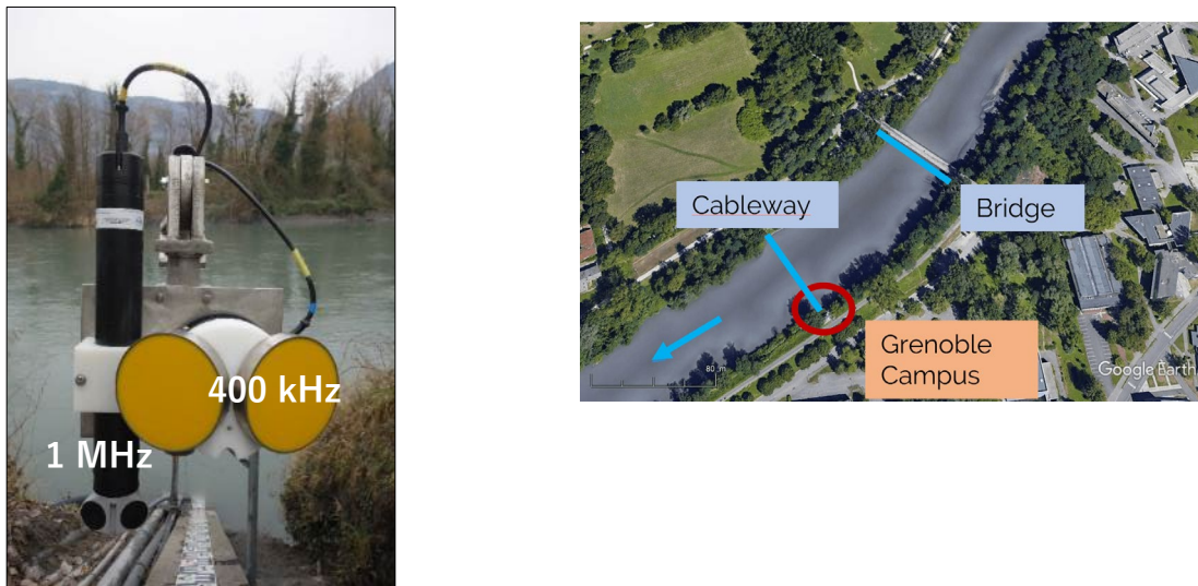
Figure 2 : Station hydro-acoustique à Grenoble-Campus : capteurs (a) et position de la section « Cableway » sur le campus de Grenoble à Saint-Martin-d'Hères (b).
