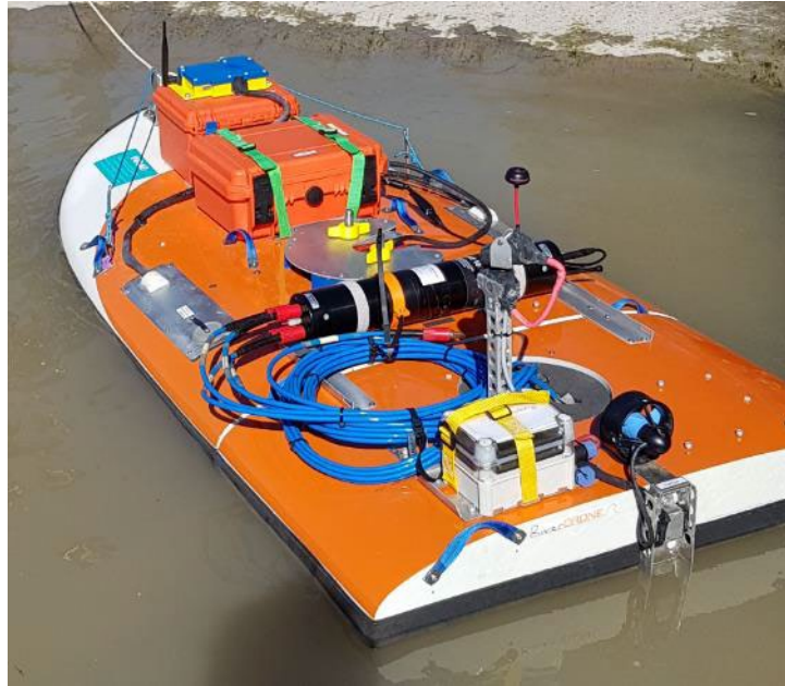
Figure 4 : AQUAscat 1000R déployé par INRAE sur le Rhône sur un drone aquatique.
