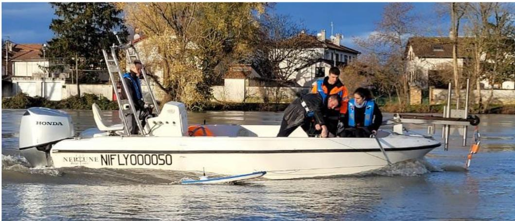
Figure 6 : UBsediflow déployé sur une planche à couple d'un bateau du CACOH (CNR)
